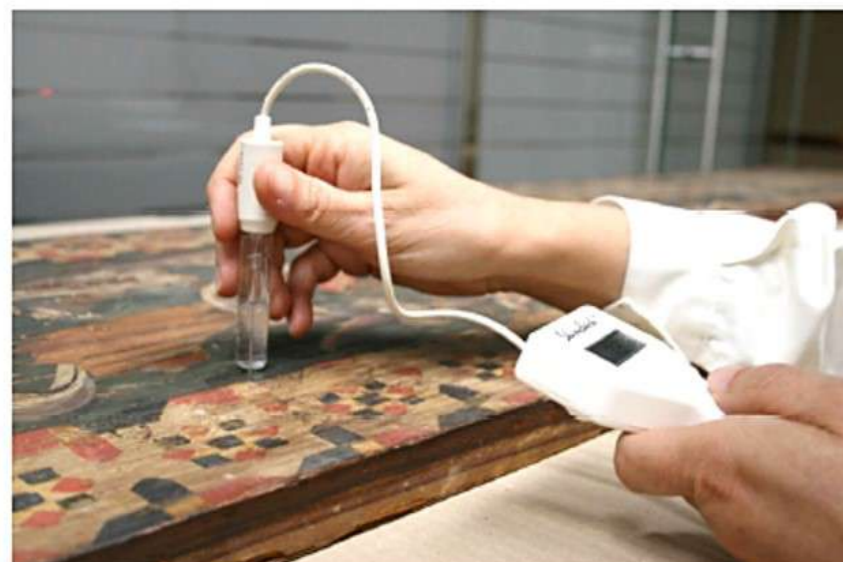
Fase 8 - Misurazione del pH mediante l'uso di un piaccometro da contatto e indagini diagnostiche sui pannelli
