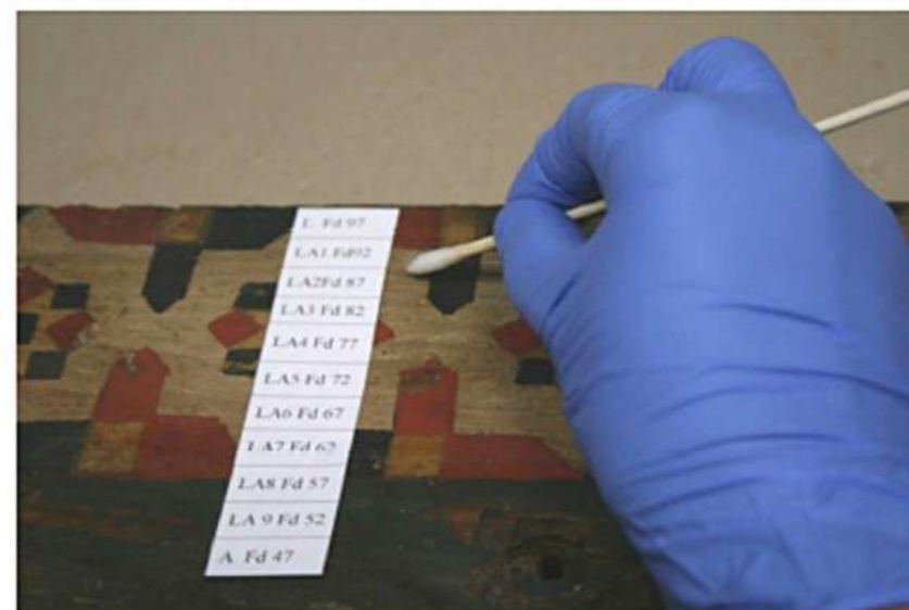
Fase 11 - Esecuzione di test acquosi con diversi gradi di pH e test di solubilità con solventi organici e solventi "green", al fine di verificare mediante osservazione a luce visibile e ultravioletta la miscela idonea per gli strati filmogeni da rimuovere. Successiva pulitura delle superfici.
